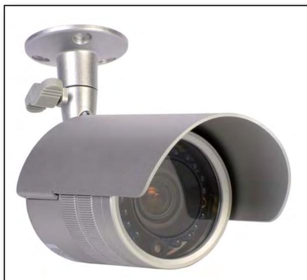
La MTC-EX4 est équipée d'un objectif à focale variable de 4,0 mm. La MTC-EX39V dispose d'un secteur d'opération de 3,0 mm – 9,5 mm. La distance focale se règle facilement sans nécessité d'ouvrir le caisson et sans perturber la classe de protection IP66. Le bras de montage se trouvant dans la quantité livrée permet la fixation aux plafonds et aux murs.
