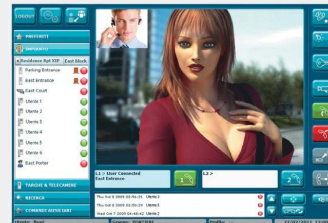
En cas d'appel, l'image provenant de la plaque apparaîtra en plein écran tandis que l'image du portier apparaîtra dans la fenêtre au moyen de la fonction PIP (picture in picture). En cas de renvoi de l'appel de la plaque à un poste interne, l'image reçue sera l'écran externe avec le PIP du portier.
