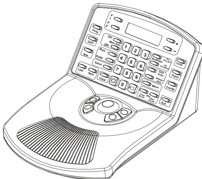
Figure 8. Disposition du clavier de matrice ADTTE Tracker
