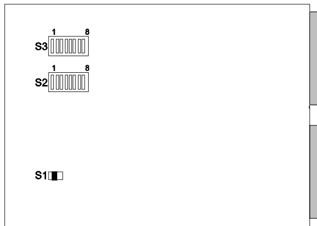
Figure 14. Emplacement des interrupteurs AD2010DB
