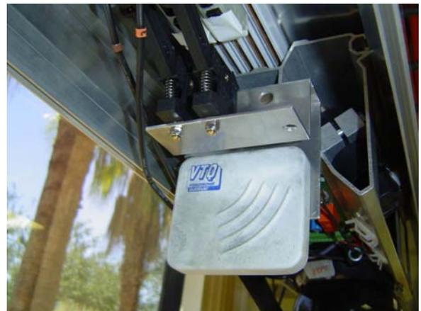
Le support plus petit doit être monté sur l'autre côté du chariot.
