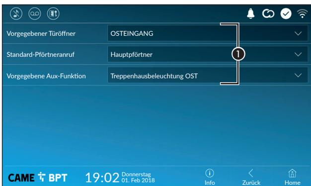
In diesem Fenster können Sie festlegen, welche Schaltbefehle durch Druck auf die Schaltflächen auf der linken Seite der Homepage ausgeführt werden sollen.
