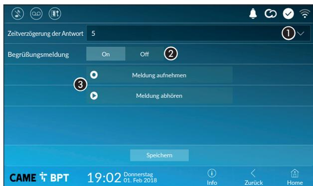
1 Wählen Sie im Drop-Down-Menü die Klingeldauer (in Sekunden), nach der die automatische Aufnahme aktiviert wird.
