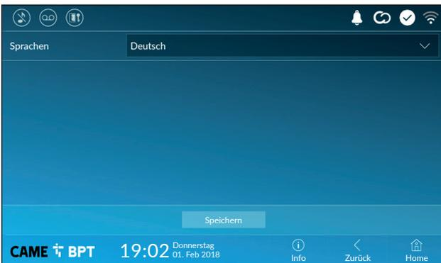
Im Dropdown-Menü die Sprache der Benutzeroberfläche wählen. Die Konfiguration mit der entsprechenden Taste **Speichern**.
