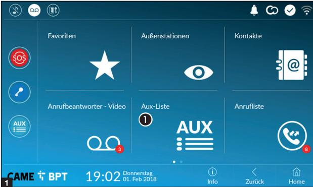
1 Tippen Sie auf das Symbol, um auf die Liste der zusätzlichen Schaltkontakte zuzugreifen. Mit den zusätzlichen Schaltbefehlen (AUX) können Sie entsprechend programmierte Kontakte aktivieren, die beim üblichen Öffnen der Tür zusätzliche Schaltbefehle ausführen.
