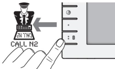
Drücken Sie mindestens 2 Sekunden lang die Taste  $\Delta$ ; die Innensprechstelle gibt ein akustisches Signal (Piepton) aus und die rote LED geht an, um zu bestätigen, dass das Paniksignal zusammen mit der Nummer des Anrufenden an den Pfortner geschickt wurde.
