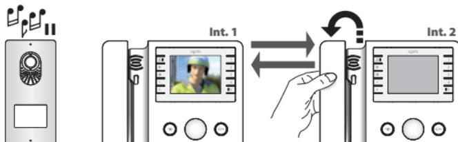
Wenn an der angerufenen Innensprechstelle der Hörer abgehoben wird, ist das Gespräch zwischen beiden aktiv; die Außenstation bleibt in Warteposition.
