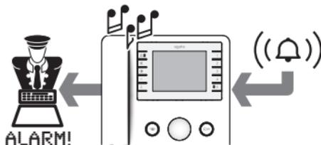
Die Aktivierung eines Alarmkontaktes, der mit dem entsprechenden Eingang der Innensprechstelle verbunden ist, führt zum Versand einer Meldung an den Pfortner und es ertönt etwa 10 Sekunden lang ein intermittierendes akustisches Signal.
