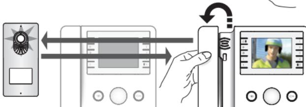
Zum Aufnehmen der Audio-Kommunikation mit der Außenstation den Hörer abheben.
