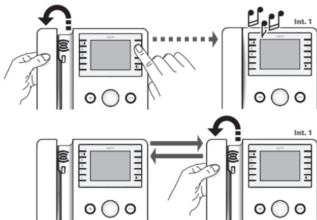
Zum Aufruf einer Innensprechstelle heben Sie den Hörer ab und drücken die Taste der gewünschten Innensprechstelle. Während einer Kommunikation zwischen Innensprechstellen wird diesen ein Anruf von einer Außenstation mit einem Piepton angezeigt, der alle 5 Sekunden wiederholt wird.
