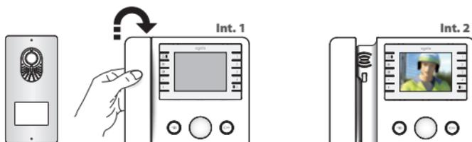
Um die Innensprechstelle 2 mit der Außenstation zu verbinden, muss die Innensprechstelle 1 den Hörer auflegen.
