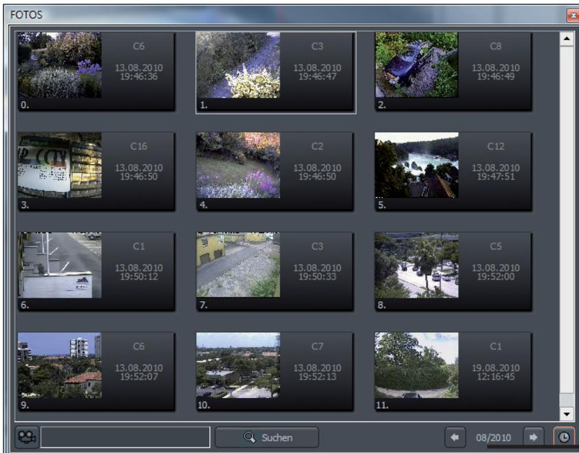
Der Fotoalbum zeigt alle die während der Arbeit mit dem System aufgenommenen Fotos an. Es ist möglich, Fotos nach besonderen Kameras, und Monaten zu sortieren. Die Einzelbilder sind versehen mit der Kameranummer, Zeit, Datum und unter deren Bezeichnung der Schnappschuss abgespeichert wurde. Doppelklicken auf die Miniaturansicht vergrößert das Bild.
