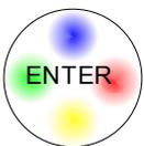
Drücken Sie kurz die ENTER-Taste. Der Controller quittiert die Eingabe mit dem kurzen Aufleuchten aller LEDs in der ENTER-Taste. Nach kurzer Zeit sind die LEDs wieder aus und es dauert noch einen kurzen Moment bis der Controller über eine eindeutige Anzeige mit nur einer LED den Betriebszustand der Kamera signalisiert.
