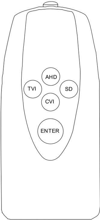
Der UTC-Controller dient zur Steuerung von Überwachungskameras, zur Wahl der Betriebsart, zur Fokus- und Zoomeinstellung und zur Bedienung des OSD-Menüs der Kamera. Der Controller unterstützt HD-CVI, AHD, HDTVI und CVBS. Er hat ein ca. 50 cm langes Anschlusskabel zum Einschleifen der Anschlussleitung in eine bestehende Videoleitung.
