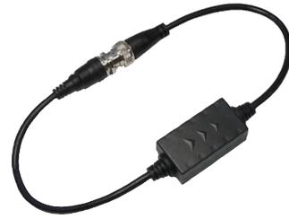
Der L-ZU-1770 ist ein passiver, galvanischer Video-Trenntrafo (geeignet für HD-CVI) und dient zur Vermeidung von Brummschleifen im Videosignal, die aufgrund eines Potentialgefälles bei größeren Entfernungen auftreten können. Der L-ZU-1770 wird einfach an der Rekorderseite zwischengeschaltet und filtert diese Störsignale heraus. Durch seine geringe Größe ist er flexibel auch in bestehende Systeme integrierbar.
