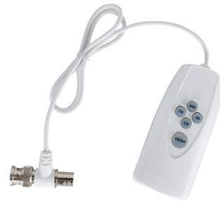
Der UTC Controller L-ZU-1760 dient zur Steuerung des OSD-Menüs von Überwachungskameras. Hierzu wird einfach in das Videosignal eingeschleift (BNC-Stecker und BNC-Buchse). Der Controller unterstützt HD-CVI, AHD, HDTV und CVBS. Eine LED zeigt das aktuell eingestellte Format an. Die Kabellänge am Controller beträgt ca. 56cm.
