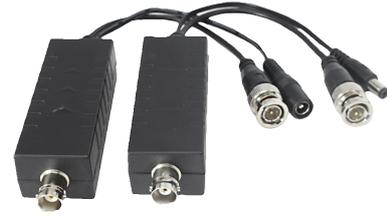
Der L-ZU-1750 ist ein Sender/Empfänger-Set für die Übertragung von HD-CVI/AHD/TVI und CVBS-Signalen bis 1080p mit Spannungsübertragung (bis zu 12VDC/9W, kabel- und entfernungsabhängig). Spannungsversorgung (Sender) ist 24-36VDC, Netzteil nicht im Lieferumfang.
