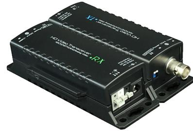
Der L-ZU-1745 ist ein Sender/Empfänger-Set für die Übertragung von HD-CVI/AHD/TVI und CVBS-Signalen bis 1080p über bis zu 500m Reichweite (HD-CVI). Die Übertragung erfolgt über Zweidraht (Klemmleistenanschluss), das anliegende Videosignal wird mit Dip-Schaltern gewählt. Sender und Empfänger müssen hierzu jeweils mit 12-20VDC oder 9-24VAC Spannung versorgt werden. Die Netzteile sind nicht im Lieferumfang enthalten.
