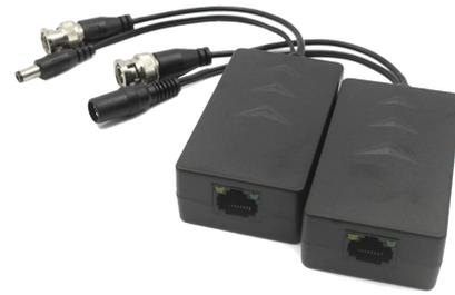
Der L-ZU-1740 ist ein passiver HD-CVI Balun mit der Möglichkeit der zusätzlichen Spannungsversorgung an Kameras (12VDC, bis zu 8W, je nach Entfernung und Spannungsversorgung). Videosignal und Spannungsversorgung werden über UTP Cat 5e/6 Kabel übertragen (RJ45 Anschlüsse). Hierzu werden zusätzlich 24-36VDC eingespeist. (Netzteil nicht im Lieferumfang)
