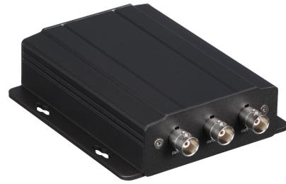
Die L-ZU-1715 ist ein HD-CVI Splitter mit einem Eingang und 3 Ausgängen. Unterstützt werden Auflösungen bis 720p mit bis zu 60fps und 1080p mit bis zu 30fps. Der Verteiler verfügt über einen außergewöhnlich großen Temperatureinsatzbereich von -40°C bis +75°C. Die Spannungsversorgung erfolgt über 12VDC (Netzteil nicht im Lieferumfang).
