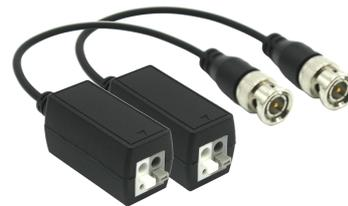
Der L-ZU-1540 ist ein Sender/Empfänger-Set für die Übertragung eines HD-CVI Signals über Zweidraht bis zu 400 Meter (720P) bzw. 250 Meter (1080P).
