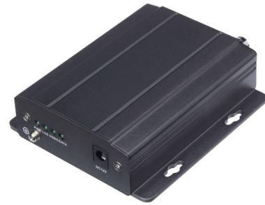
Der L-ZU-1521 ist ein Konverter von LWL (Glasfaser) auf HD-CVI und fungiert als Empfänger für den Sender (Artikel L-ZU-1520). Diese Ausführung unterstützt Singlemode-Fiberoptikkabel, die Übertragungreichweite beträgt hiermit bis zu 20km. Die Spannungsversorgung erfolgt über 12VDC/1A (Netzteil nicht im Lieferumfang).
