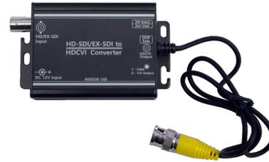
Der L-ZU-1501 ist ein Konverter für HD-SDI auf HD-CVI. Die Spannungsversorgung erfolgt über 12VDC. Das Netzteil ist nicht im Lieferumfang enthalten.
