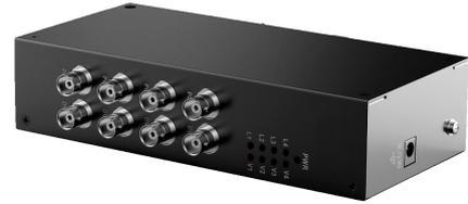
Der Midspan L-MS-2804 dient zur Einspeisung einer PoC-Spannung (12VDC/max. 15,6W) zur Übertragung über Koax an bis zu vier HD-CVI Kameras (720p/1080p) über eine Strecke von max. 400 Metern. Bis zu vier Kameras werden dann kameraseitig entweder direkt mit Spannung versorgt über BNC oder mit Hilfe des PoC Splitters L-SP-2801 (separat erhältlich) auch über 12VDC per Hohlstecker. Die Spannungsversorgung erfolgt über 12-36VDC, im Lieferumfang befindet sich ein Netzteil 24VDC/3A.
