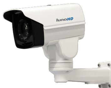
Die L-KS-2600 ist eine PTZ-Kamera mit 4-fach optischem Zoom (2,8 mm ~ 12 mm) und IR-Beleuchtung (bis zu 50 m). Besonderheit der Kamera ist die kompakte Bauform kombiniert mit der PTZ-Funktionalität. Der 1/2,8" CMOS Sensor liefert eine max. Auflösung von Full HD (1920 x 1080 px) mit bis zu 25 Bildern pro Sekunde. Die Kamera ist wettergeschützt (IP66). Für die Einstellungen der Kamera und Aufnahme der Videos wird ein Rekorder benötigt. Die Stromversorgung erfolgt über 12 V DC.
