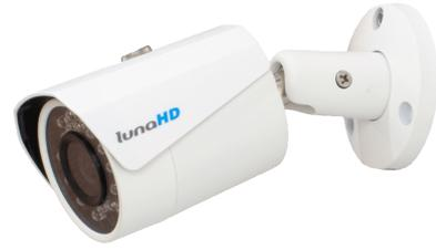
Die L-KA-2600 ist eine HD-CVI Bullet-Kamera mit IR-Beleuchtung (bis 30m). Die CVI-Technik ermöglicht die Übertragung eines analogen Videosignals in FullHD bis zu einer Länge von 500m. Die Kamera ist wettergeschützt (IP67) und verfügt über ein 3,6mm Megapixel Objektiv mit automatischer Blende (DC). Der DSP (Signalprozessor) der Kamera ermöglicht zahlreiche Einstellungen für optimale Bildqualität auch bei schwierigen Lichtverhältnissen. Die Spannungsversorgung erfolgt über 12VDC.
