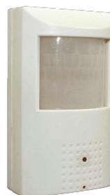
Die L-BM-2600 ist eine versteckte Mini-Kamera mit neuester HD-CVI Technik im Bewegungsmelder-Gehäuse (kein BM verbaut) mit IR-Beleuchtung. Die Kamera mit leistungsfähigem 1/2,8" Megapixel Sensor verfügt über ein 3,7 mm Pinhole-Objektiv. Der DSP (Signalprozessor) der Kamera ermöglicht zahlreiche Einstellungen für optimale Bildqualität auch bei schwierigen Lichtverhältnissen. Die Einstellung erfolgt per OSD-Menü. Die Kamera wird mit einer Spannung von 12 V DC betrieben.
