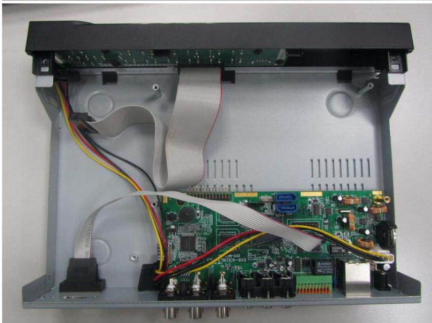
**Schritt 3) Verbinden Sie Strom- und SATA-Kabel wie angezeigt.**
