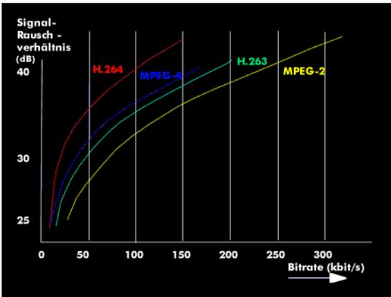
Das Baseline-Profil zielt auf die Echtzeitkommunikation für Endgeräte, und somit auf Videokonferenzen und Videotelefonaten. Es verwendet die fortlaufenden I-Frames und Predicted-Frames sowie die CAVLC-Transformation. Aufgrund der robusten Fehlertoleranz und niedrigen Latenzzeiten hat das Baseline-Profil seine besonderen Stärken bei dynamischen Netzen auf denen die Videodaten mit geringer Bandbreite übertragen werden.
