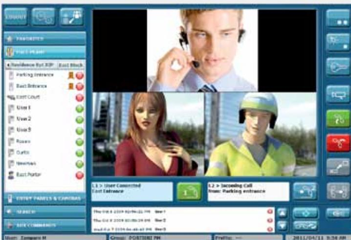
Für den Fall, dass während eines Gesprächs ein weiterer Anruf eingeht, werden die Bilder wie in der Abbildung gezeigt angeordnet, und durch Drücken der entsprechenden Tasten kann jeweils einer der beiden Anrufe angenommen oder in die Warteschleife gesetzt werden.
