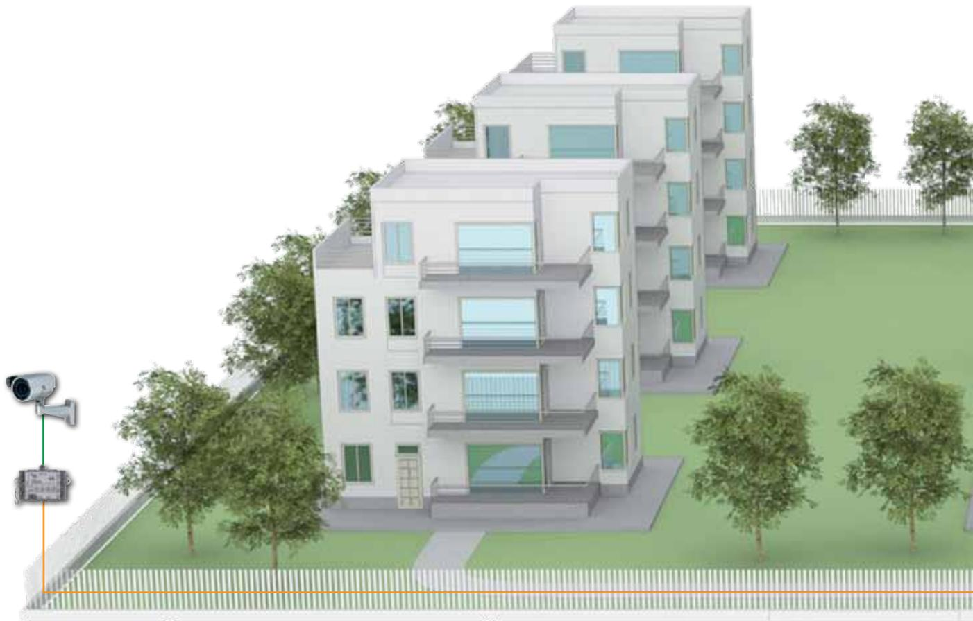
Es ist möglich, Anlagen für Wohnkomplexe mittlerer Größe mithilfe der Stammleitung zwischen dem Haupteingang bzw. den Haupteingängen und den einzelnen Wohneinheiten (Wohnungen und/oder Gebäude) mit einem normalen, nicht polarisiertem Twisted-Pair-Kabel zu realisieren (für maximale Leistungen kann das dafür vorgesehene Kabel Bpt Typ VCM/1D verwendet werden).
