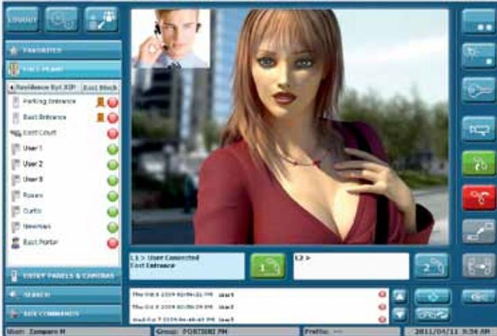
Bei einem Anruf erscheint im Vollbildmodus das Bild von dem Tableau und im PIP (Picture in Picture) das Bild der Pförtnerzentrale. Wenn ein Anruf vom Tableau an eine Innensprechstelle weitergeleitet wird, ist das empfangene Bild das externe Video mit dem PIP der Pförtnerzentrale.
