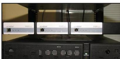
den dezentralen Einsatz der Encoder in der Nähe von Kameras oder Domen. Encoder können in ein Rack eingebaut, auf einen Tisch gestellt oder mit dem optionalen Wandmontage-Set montiert werden. Für die 1HE-Rackmontage ist ein Einbau-Set verfügbar. Das Rackmontage-Set ist jeweils für mindestens drei Encoder.
