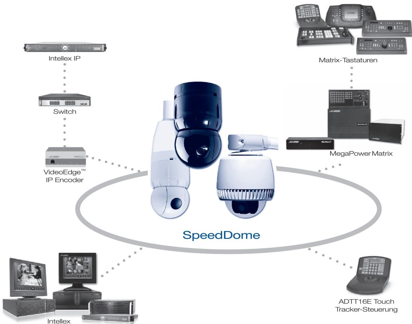
Die SpeedDome sind kompatibel mit jeder Intellex oder MegaPower Matrix/Steuerung und dazugehöriger Tastatur, wie die MegaPower 48 Plus, ControlCenter 1100 und Fremdsteuerungen. In der Basiskonfiguration bedienen Sie Ihre Dome mit der ADTT16E Touch Tracker-Steuerung. Es wird Ihnen eine ausgezeichnete Videoqualität und einfache Verwendung mit jeder gewählten Option garantiert.
