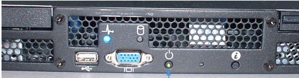
Die grüne Anzeige bedeutet, dass Betriebsspannung im Gerät anliegt. Um Intellex IP zu starten, müssen Sie allerdings noch den Netzschalter drücken.
