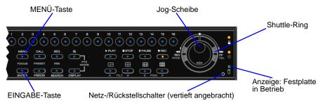
3 Drücken Sie zum Einstellen von Datum und Uhrzeit auf die Menütaste Wählen Sie "Schnelleinstellungen" und drücken Sie anschließend die Eingabetaste. Verwenden Sie den Shuttle-Ring, um das Datum und die Uhrzeit einzustellen. Drücken Sie die Menütaste, um das Hauptmenü zu verlassen.
