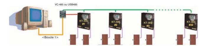
L'architecture du logiciel EntraPass Special Edition nécessite l'installation d'un contrôleur KT-300 pour chaque paire de deux lecteurs. Les capacités maximales diverses autorisées par le logiciel EntraPass sont indiquées ci-dessous :
