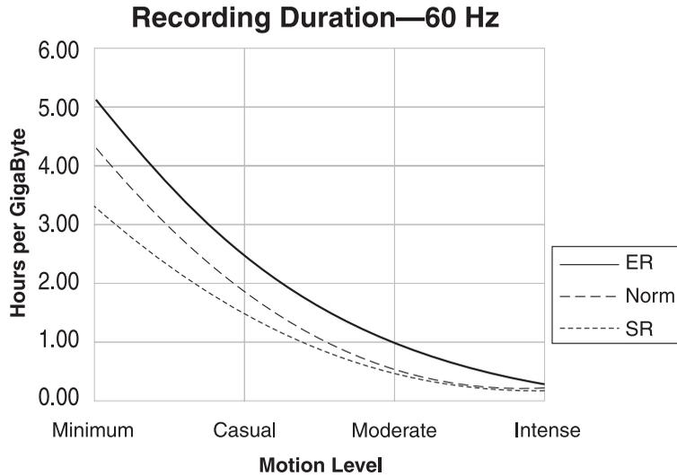
Figure 14 — Facteurs de capacité d'enregistrement à 60 ips
