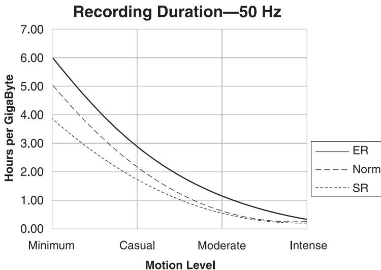
Figure 15 — Facteurs de capacité d'enregistrement à 50 ips
