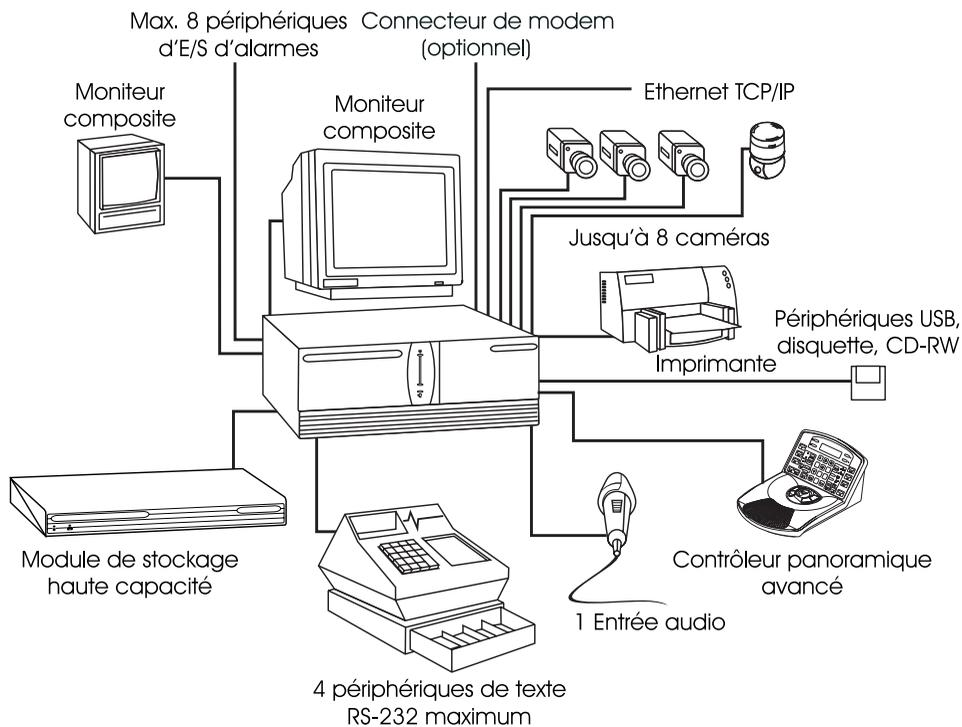
Figure 2 — Système Intellex de base
