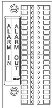
Figure 13 — Connecteurs d'alarme sur le panneau arrière
