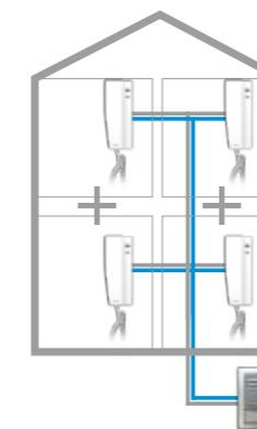
Beispiel für eine Erweiterung innerhalb einer Einzellanlage
