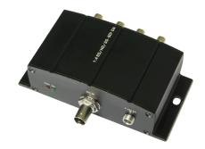
Die L-ZU-1315 ist ein HD-SDI Splitter mit einem Eingang und 4 Ausgängen. Die Box fungiert zudem als Repeater. Die Spannungsversorgung erfolgt über 6~12VDC (Netzteil im Lieferumfang).
