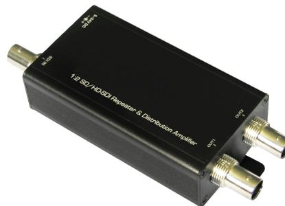
Die L-ZU-1305 ist ein Repeater für ein HD-SDI Signal mit 2 HD-SDI Ausgängen. Die Box verstärkt ein aufgenommenes HD-SDI Signal und ermöglicht so eine Erweiterung der maximalen Kabellänge. Die Spannungsversorgung erfolgt über 6~12VDC (Netzteil im Lieferumfang).
