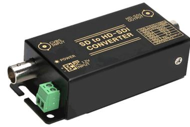
Die L-ZU-1301 ist ein Konverter für Analogsignale(SD) auf HD-SDI. Die Box besitzt einen BNC-Eingang und einen SDI-Ausgang. Das Ausgangssignal kann über Dip-Schalter angepasst, werden (HD/FullHD, Bildrate, Bildformat). Die Spannungsversorgung erfolgt über 12VDC (Anschlussklemmen, Netzteil im Lieferumfang).
