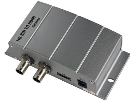
Der L-ZU-1300 ist ein Konverter für HD-SDI auf HDMI. Die Box besitzt einen SDI-Eingang und zusätzlich zu dem HDMI-Ausgang noch 1 SDI-Ausgang. Somit fungiert das Gerät gleichzeitig auch als Repeater. Die Spannungsversorgung erfolgt über 6~12VDC (Netzteil im Lieferumfang).
