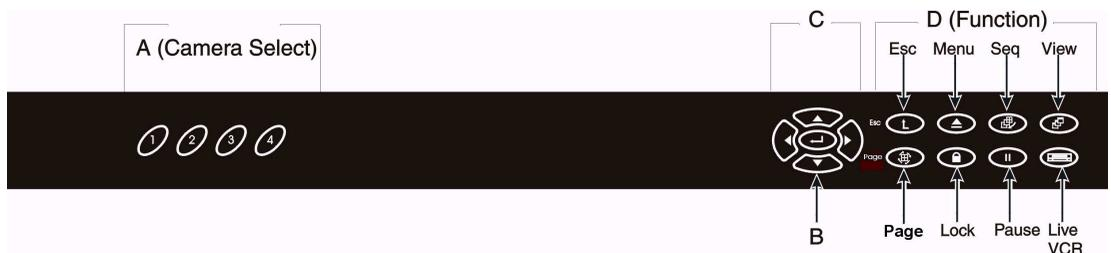
Figura 6 — Panel frontal del multiplexor dúplex de cuatro canales
